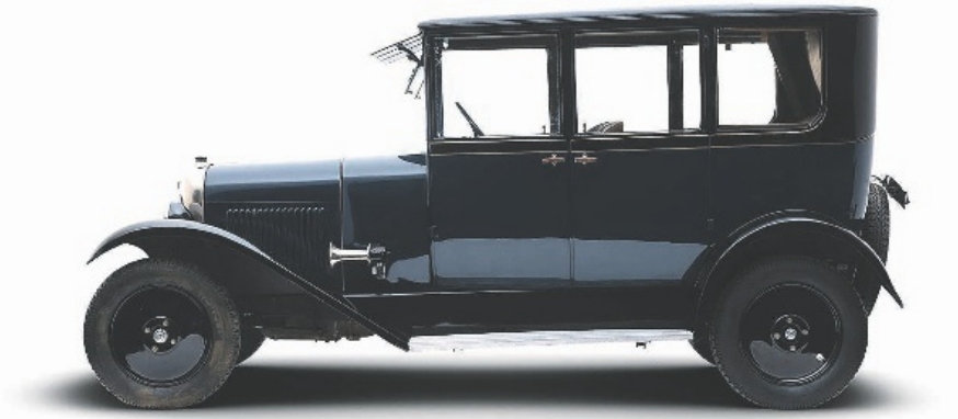
Citroën setzte 1924 mit der Produktion des B10 erstmals auf die Ganzstahlkarosserie.
