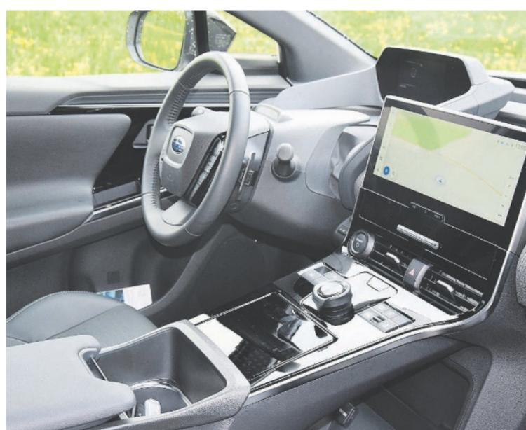
«Peugeoteskes» Instrumentarium; Tacho über dem Lenkradkranz.
