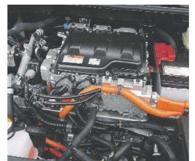
Der zweite Elektromotor für den Allrad ist vorne.
