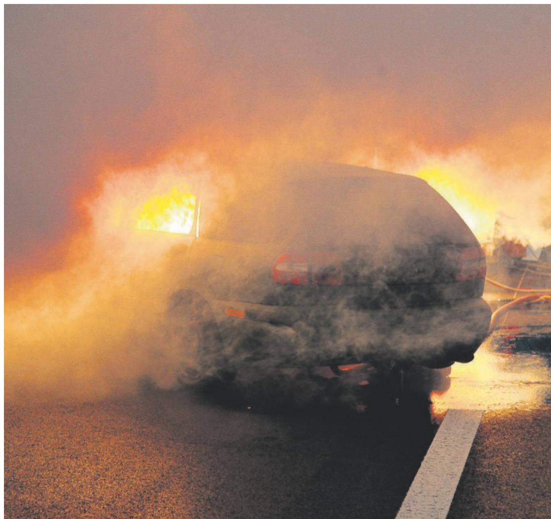
Schon wenige Minuten nach Brandausbruch legt sich ein dichter Nebelschleier in die Tunnelröhre. Weil es nur weisser «Discorauch» (Basis Propylenglykol) ist, droht keine Gefahr. Im Ernstfall ist der Rauch meist schwarz und giftig.
