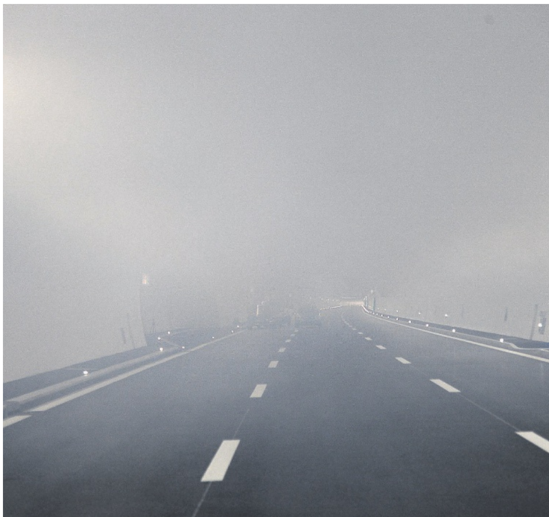
Schon wenige Minuten nach Brandausbruch legt sich ein dichter Nebelschleier in die Tunnelröhre. Weil es nur weisser «Discorauch» (Basis Propylenglykol) ist, droht keine Gefahr. Im Ernstfall ist der Rauch meist schwarz und giftig.
