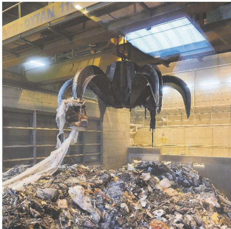
Die nützlichste Spinne der Stadt: Mit dem Greifer wird der Kehrrecht im Bunker der KVA Hagenholz für die Verbrennung vorbereitet und über den Einfülltrichter in den Feuerraum geschüttet. BILD ERZ
