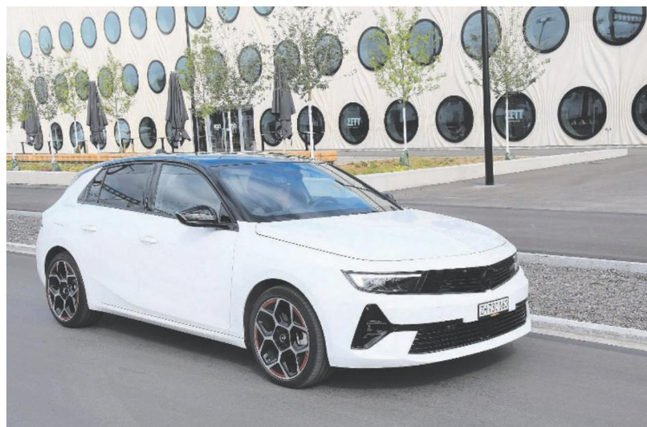
verfügt. An einer 8-A-Haushaltsteckdose sind die rund 45 maximal erreichbaren rein elektrischen Kilometer in sechs Stunden erreicht, mit einer 16-A-Wallbox genügen drei Stunden tanken, und damit lädt der Astra PHEV bis auf 100 Prozent, das heisst auf eine elektrische Reichweite von gut 55 Kilometern.
