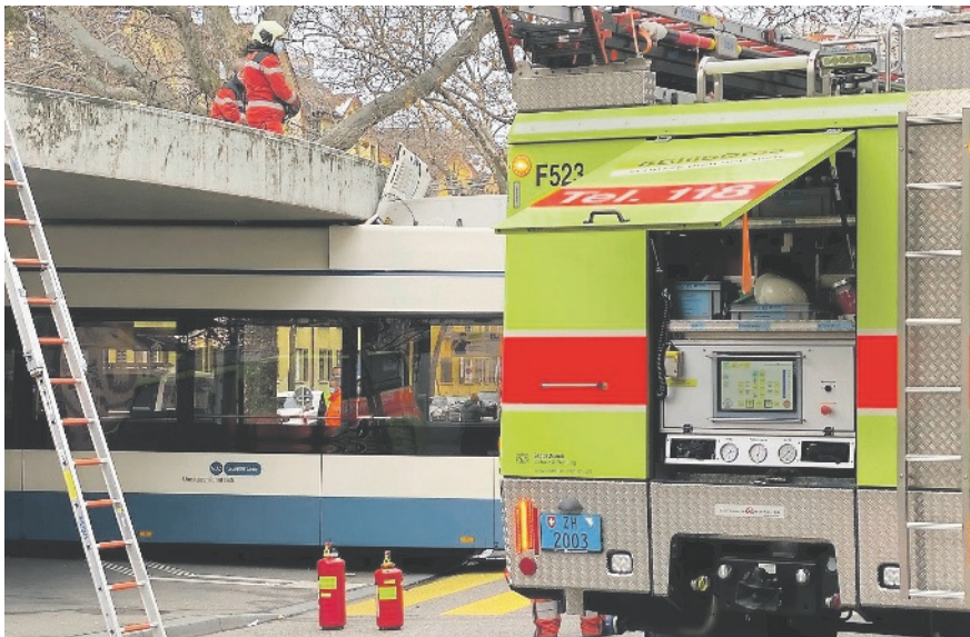
Das Akkupaket des Doppelgelenkbusses kollidierte mit dem Dach der Haltestelle.
